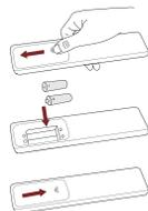
1. Deslize a tampa traseira para abrir o compartimento das baterias do controlo remoto.
